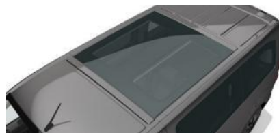
Presklená strecha so snečnou clonou (oK01)
